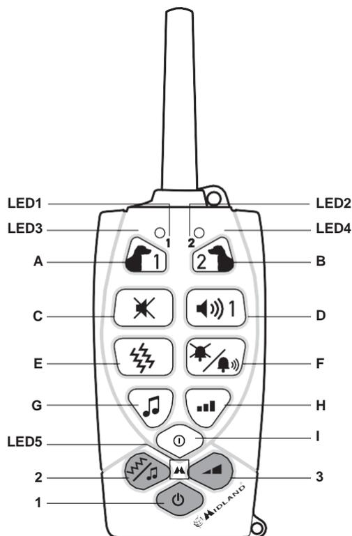
**Tasti A e B** Servono a selezionare il collare: pulsante giallo per il collare 1, pulsante blu per il collare 2..
